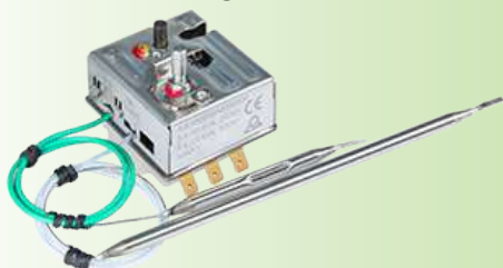
1-poliger Thermostat mit manueller Rückstellung, hoher Grenzwert, ausfallsicher, feste Einstellung, Temperaturbereich bis 320°C
