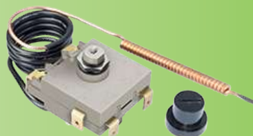
2-poliger Thermostat mit manueller Rückstellung, hoher Grenzwert, ausfallsicher, feste Einstellung, Temperaturbereich bis 170°C
