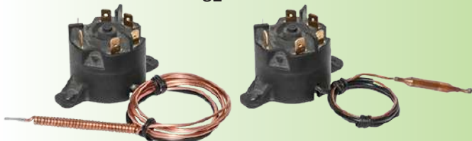
3-poliger Thermostat mit manueller Rückstellung, hoher Grenzwert, ausfallsicher, feste Einstellung, Temperaturbereich bis 170°C
